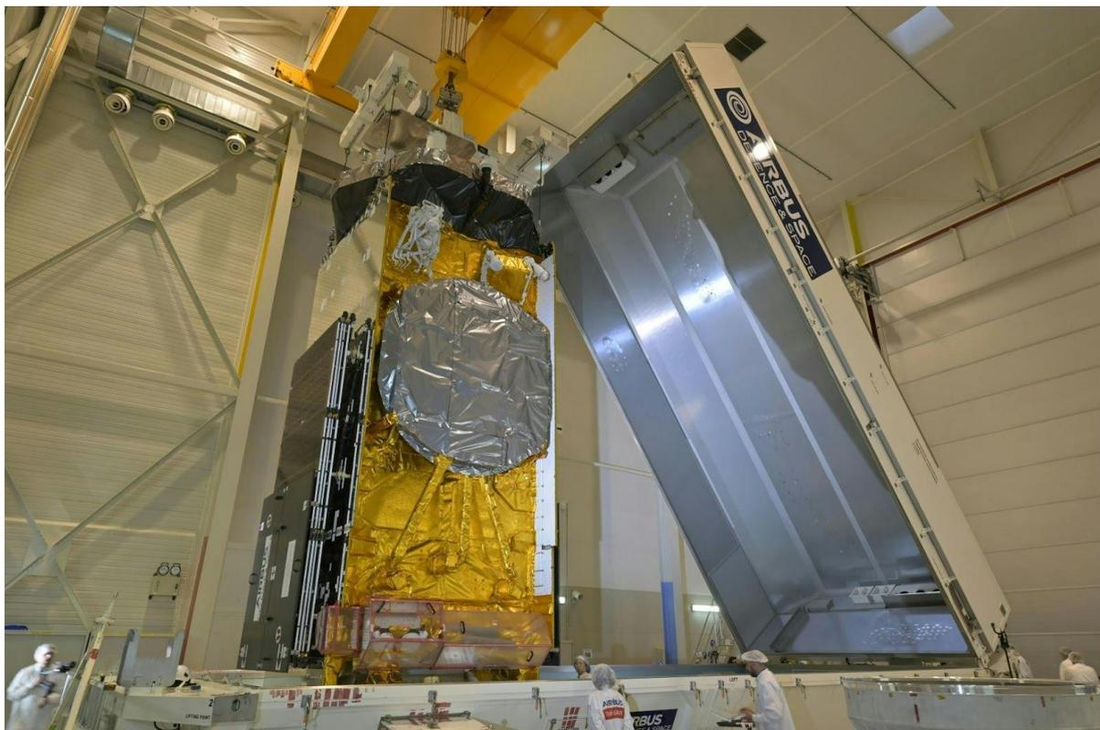
Le satellite Eutelsat 36D est installé dans son conteneur - Copyright Airbus
